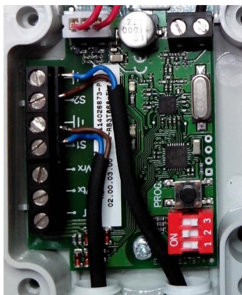
Illustration 17: Anslutning medlöpande klämskydd på JCM-sändaren RB3R868
